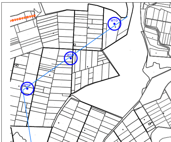
Фигура 22 Отпадащи турбини, попадащи в близост до водопровод
