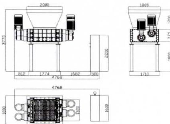
Шредерът може да преработва различни видове материали, включително дървен отпадък, индустриални отпадъци, хартия, фолия, алуминий, пластмаса и др., **като целта на преработката е редукция на размера**, като с възможността за монтиране на сито се постига и контролиране на размера на изходящата фракция.
