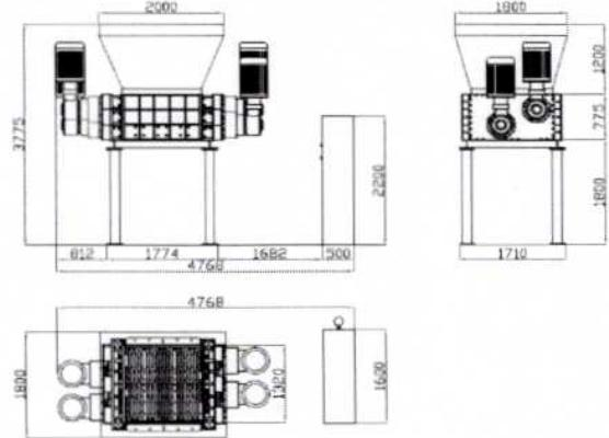
Шредерът може да преработва различни видове материали, включително дървен отпадък, индустриски отпадъци, хартия, фолия, алуминий, пластмаса и др., като целта на преработката е редукция на размера, като с възможността за монтиране на сито се постига и контролиране на размера на изходящата фракция.
