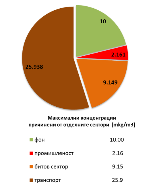
а) Максимални средногодишни концентрации на ФПЧ 10 , причинени от различните групи/сектори отделящи емисии
